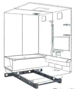
■ フレーム架台 頑丈さのひみつは浴室の重さを しっかり支えるフレーム構造の架台。
